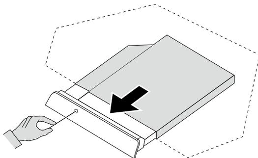
9. С помощью плоской отвертки прижмите и вытащите штифты, крепящие крышку к диску. **1 2**
