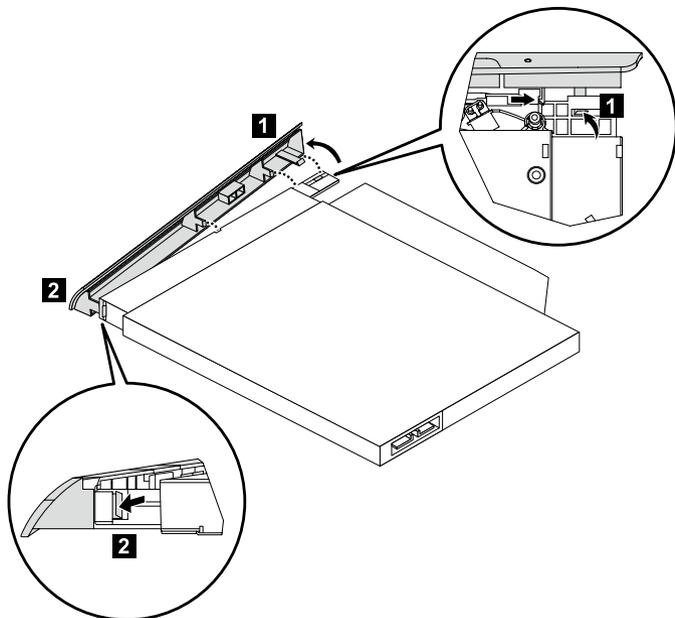
11. Установка нового дисковод оптических дисков:
