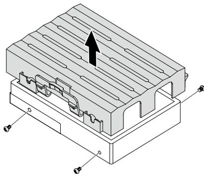
9. Отвинтите два винта, крепящих защитное устройство к жесткому диску, затем поднимите защитное устройство. (Только для модели С560.)
