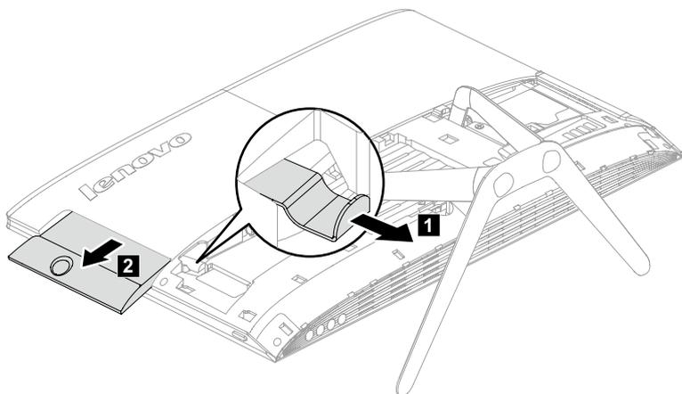
7. Снимите скобу дисководов оптических дисков.
